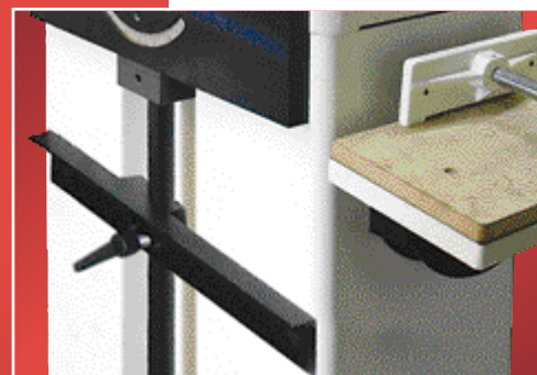
Perçage aisé de serrures de porte et d'assemblage de bois à l'aide du support inférieur de pièce
