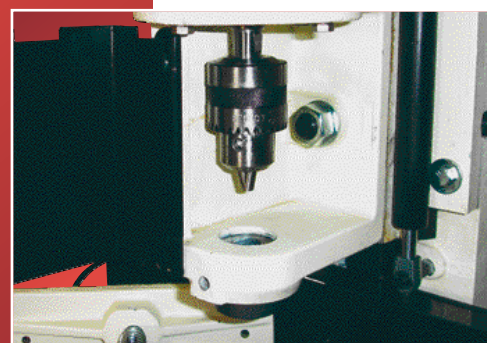
Mandrin à 3 mors, d'utilisation facile par une grande ouverture de porte
