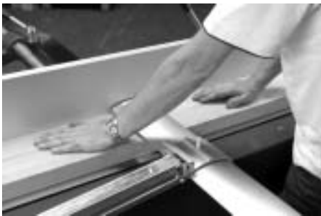
Dégauchissage sur parement
