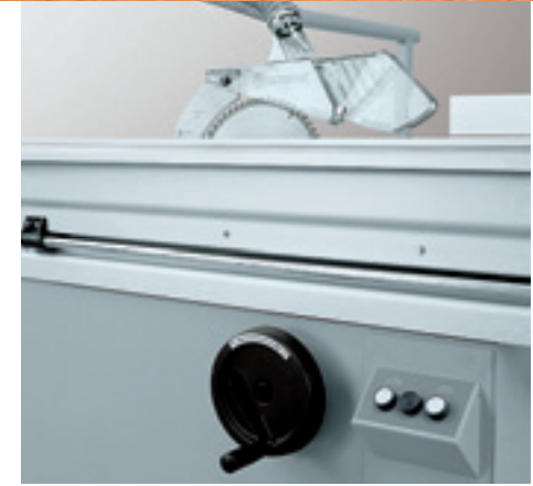
Réglage manuel de la hauteur.
