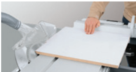
Incliner la lame de scie à l'angle désiré et mettre en appui la pièce sur le guide transversal.
