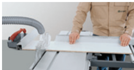
Couper les bandes de panneau à la longueur finale sur le guide parallèle.
