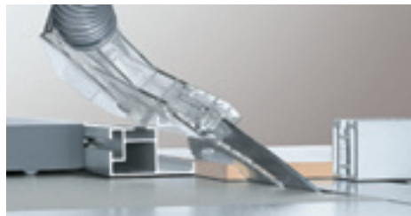
Effectuer une coupe en biseau sur le guide parallèle en maintenant la pièce sur chariot.
