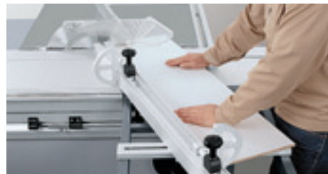
Couper d'onglet à l'aide du guide d'onglet transversal.
