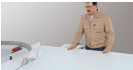
Couper des bandes de panneau sur le guide parallèle.
