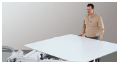
Tourner le panneau dans le sens inverse des aiguilles d'une montre et placer côté affranchi contre le guide.
