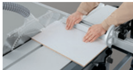
Couper la pièce restante à dimension sur le guide transversal.
