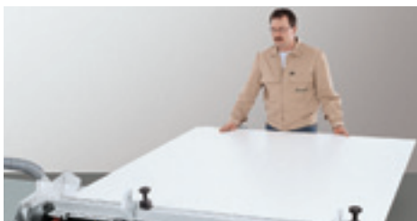
Aligner le panneau et effectuer une coupe d'affranchissement.
